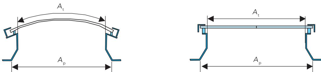
Figure 34 : Appareils avec élément de remplissage plan et courbé
